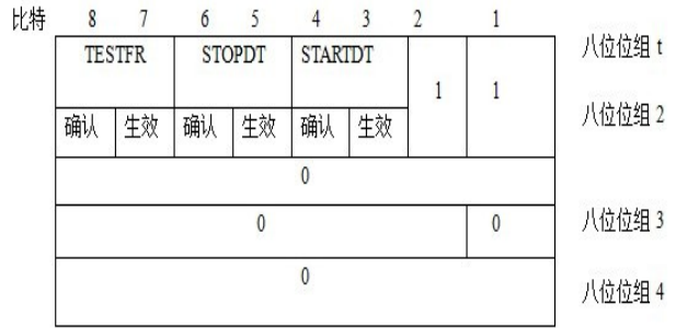
图 3 104 网络报文控制域格式图
