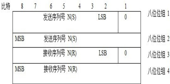
图 4 104 网络报文 I 格式控制信息图
